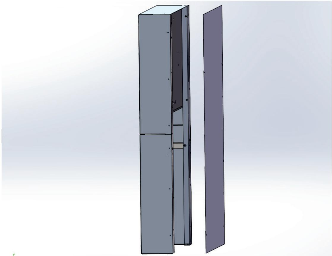
**Setzen Sie nun die Rückblende auf und verschrauben Sie diese mit den mitgelieferten M5 Flachkopfschrauben.**
