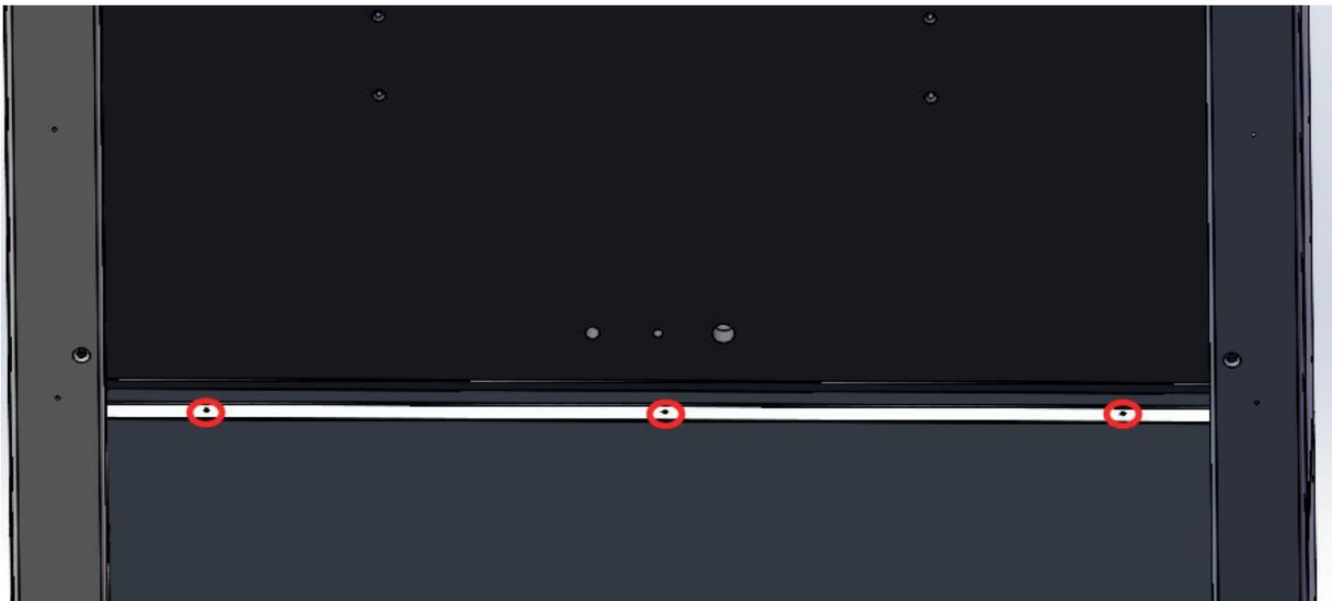
Verschrauben Sie nun die obere und untere Blende von innen mit den mitgelieferten M5 Schrauben / Mutter.
