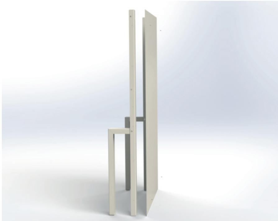
Fixieren Sie nun die Rückwand mit 4-6 Schrauben an den Trägern, um den richtigen Abstand zu gewährleisten.
