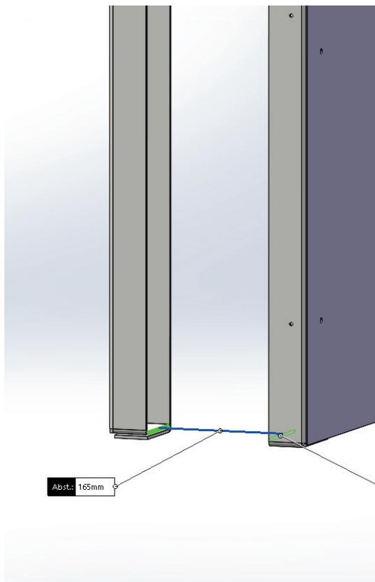
Achten Sie beim Verschrauben der Pfosten darauf, möglichst genau (+ - 1mm) den Abstand der Innenkanten von 165 mm einzuhalten.
