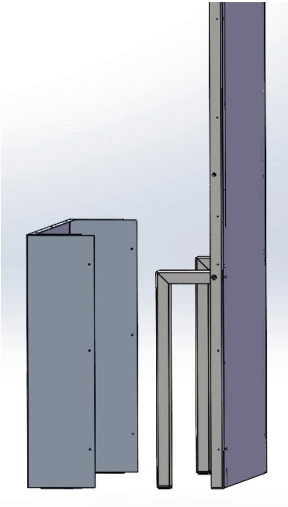
Setzen Sie die untere Frontblende auf. Verschrauben Sie die Blende seitlich mit den mitgelieferten Flachkopfschrauben M5.
